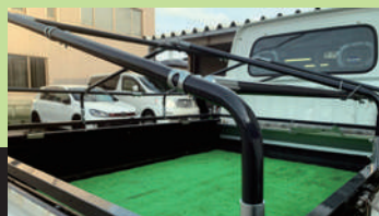
スチールフレームを錆などから守る為に、防錆塗装
