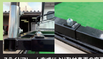
スライドフレーム方式により取付車両の変更があっても軽トラック全てに装着が可能(ハイゼットジャンボ、スーパーキャリーは除く)
